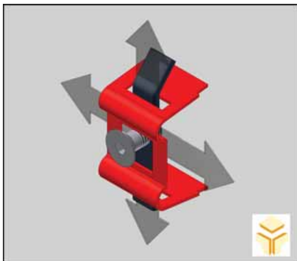
Fig. 2.3. – Pré-ajustamento (jogo de movimentos: conjunto estufa-parafuso-aro)
