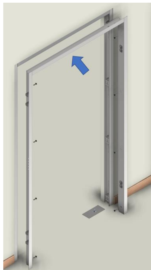
Fig. 2.1.2 – Assentamento do aro
