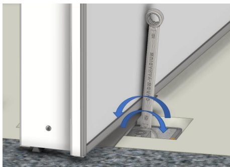
Fig. 7.3 – Colocação Chave inglesa afim de afinar a porta (eixo inferior)
