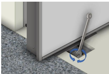
Fig. 7.3 – Colocação Chave inglesa afim de afinar a porta (eixo inferior)
