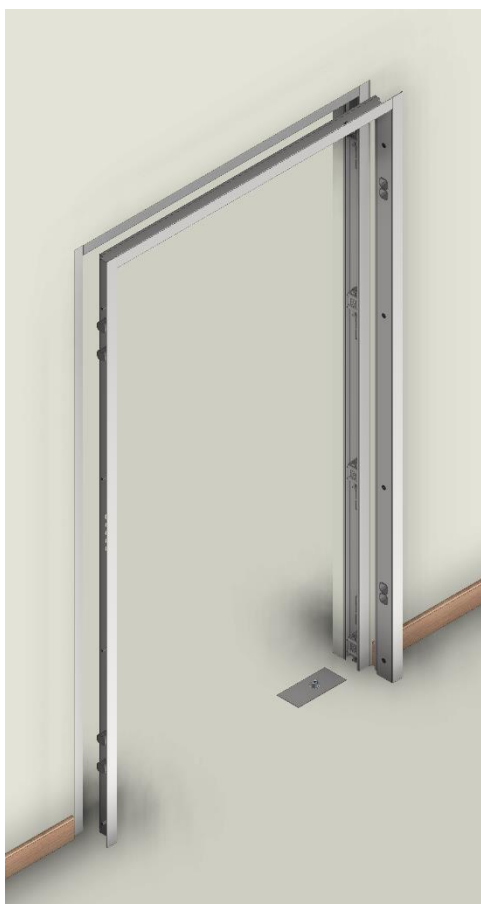
Fig. 2.1.1 – Colocação do aro
