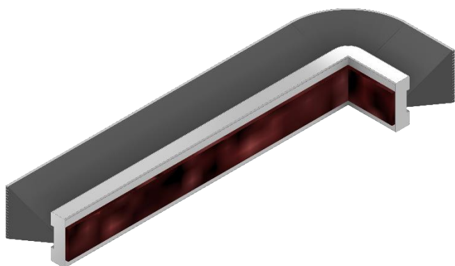
Fig. 4 – Pelúcia com curva 90° (2x) para lado da dobradiça do aro
