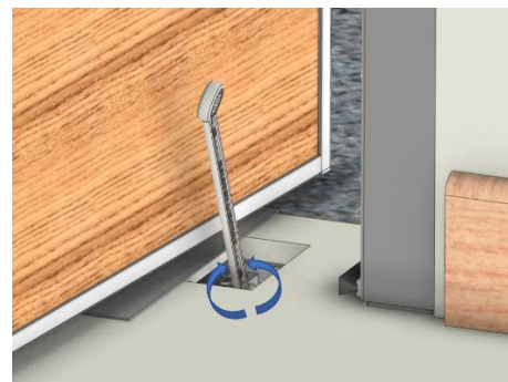
Fig. 7.2 – Afinação do pivot inferior (localização dos parafusos + porcas fixação)
