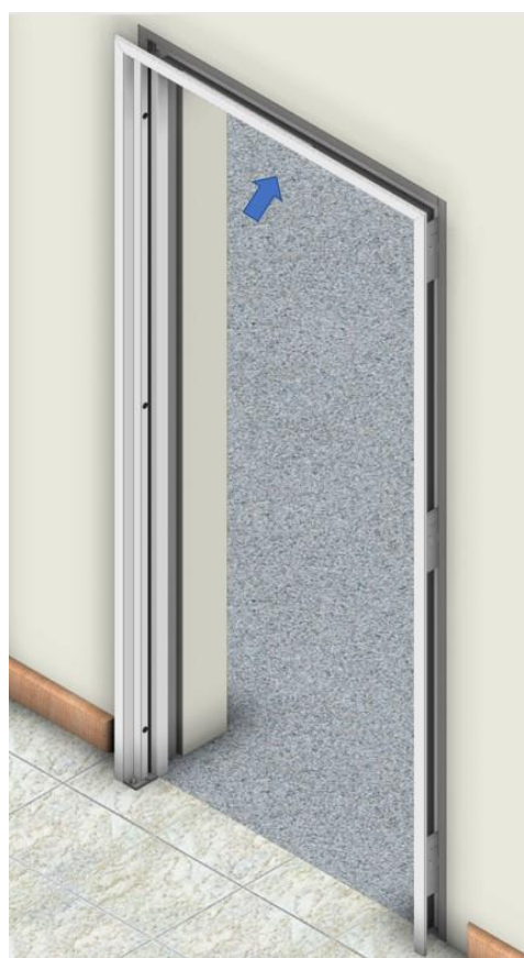
Fig. 2.1.2 – Assentamento do aro
