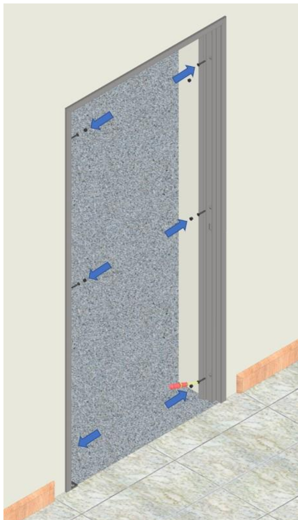
Fig. 2.2 – Colocação dos parafusos de aperto do aro ao pré-aro
