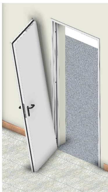
Fig. 3.2 – Pormenor da colocação da porta Linedoor.
