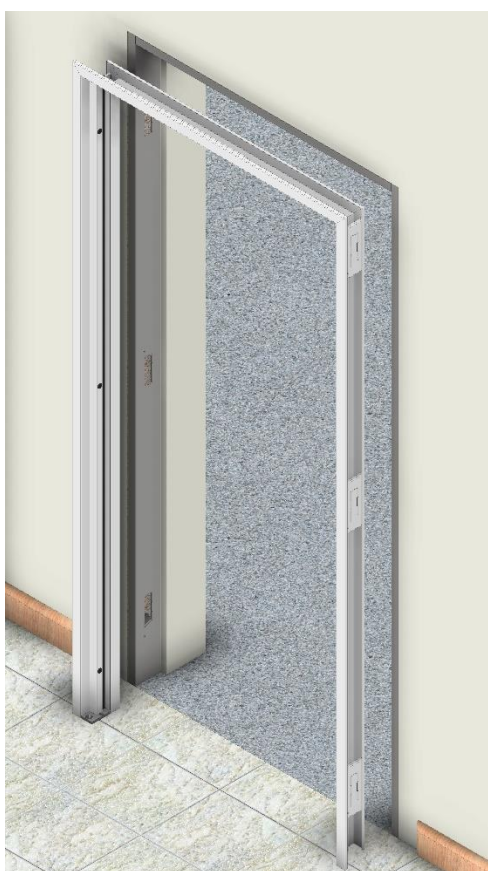
Fig. 2.1.1 – Colocação do aro
