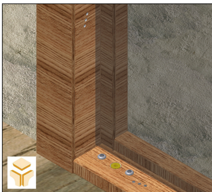
Fig. 4.2 – Fixação do vidro
