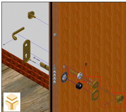
Fig. 3.5 – Montagem de ferragens (C)
