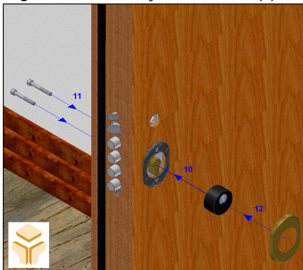
Fig. 3.4.3 – B4 Colocação do escudeto (11)
