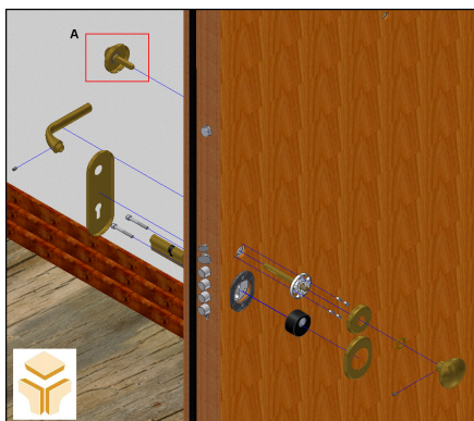
Fig. 3.3 – Montagem do espelho e manipulo do limitador de abertura (A)
