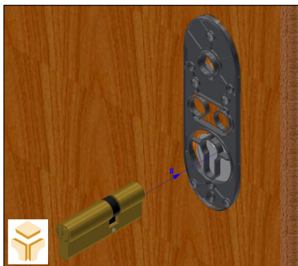
Fig. 3.4.1 - B1 Inserção do cilindro (8)
