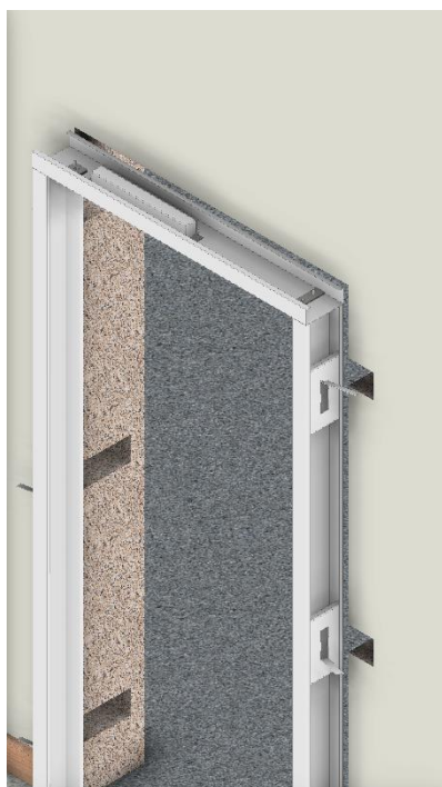
Fig. 1.1 – Colocação do aro
