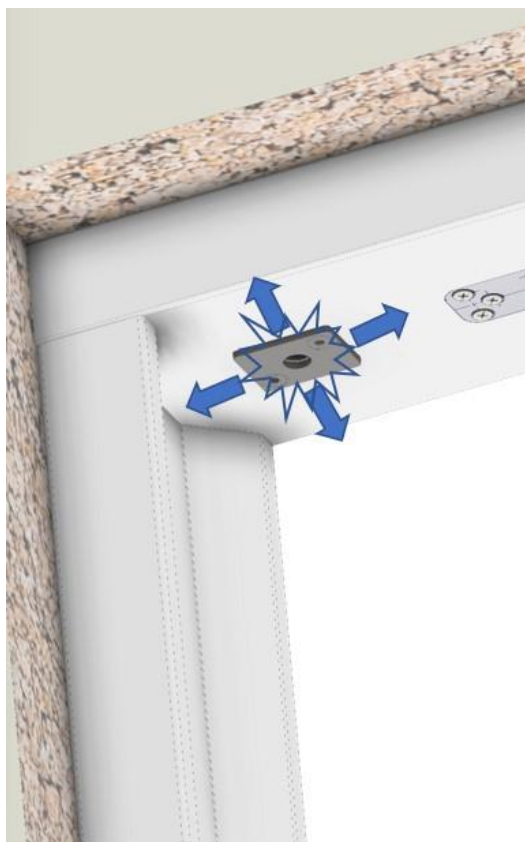
Fig. 3.7 – Afinação eixo superior sob a lateral.
