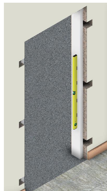
Fig. 2.1 – Assentar e nivelar o aro (nível de bolha de ar com base magnética)
