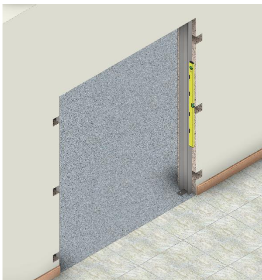
Fig. 2.1 – Assentar e nivelar o aro (nível de bolha de ar com base magnética)
