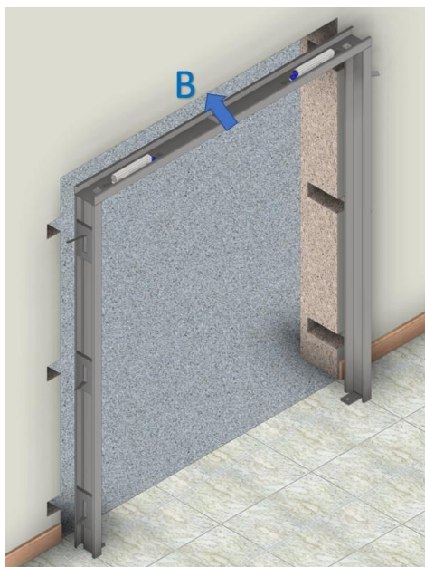
Fig. 2 – Colocação do aro (B) com as garras para dentro dos "rasgos".
