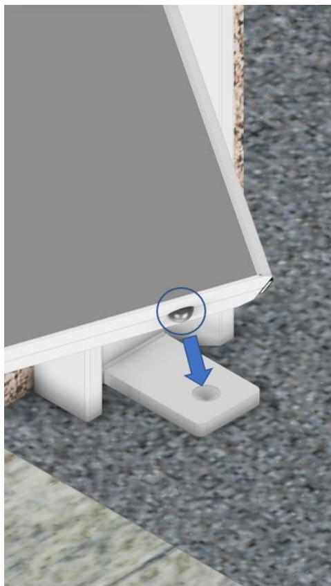
Fig. 3.3 – Pormenor da colocação da porta sob o prato inferior de giro do aro.
