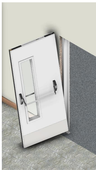
Fig. 3.2 – Pormenor da colocação da porta DSE no aro.
