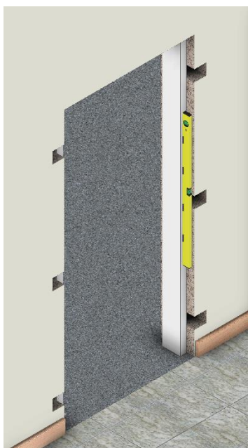
Fig. 2.1 – Assentar e nivelar o aro (nível de bolha de ar com base magnética)
