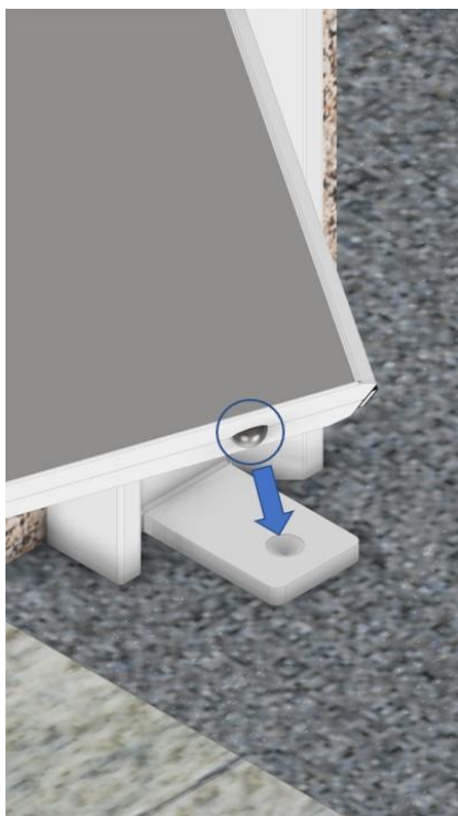
Fig. 3.1 – Pormenor chapa inferior eixo porta e esfera eixo inferior da porta.
