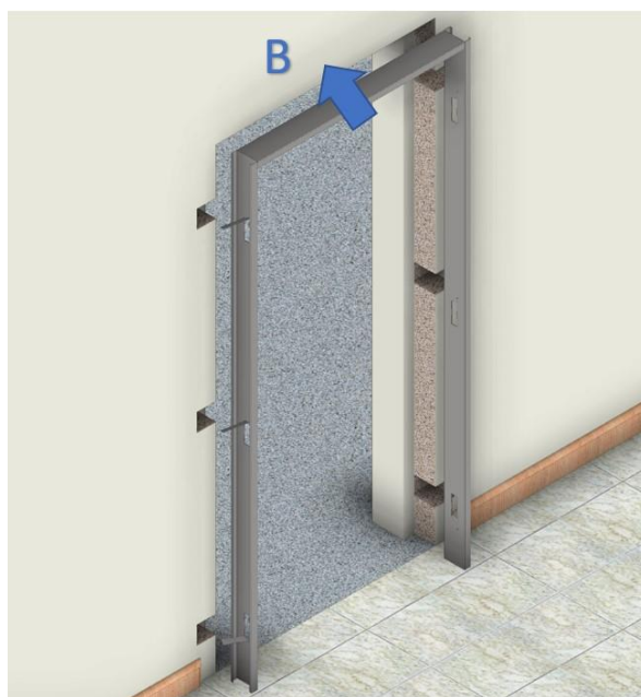
Fig. 2 – Colocação do aro (B) com as garras para dentro dos "rasgos".
