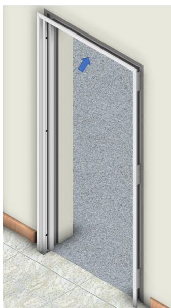
Fig. 1.2 – Assentamento do aro
